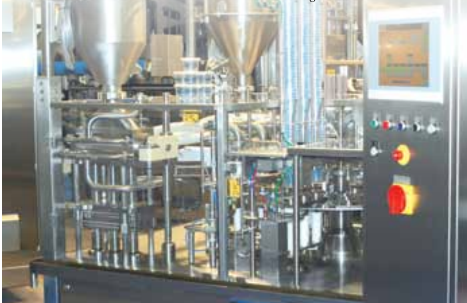
Servomotorisch angetriebene Becherfüll- und Verschleißmaschine mit integriertem Entkeimungssystem
